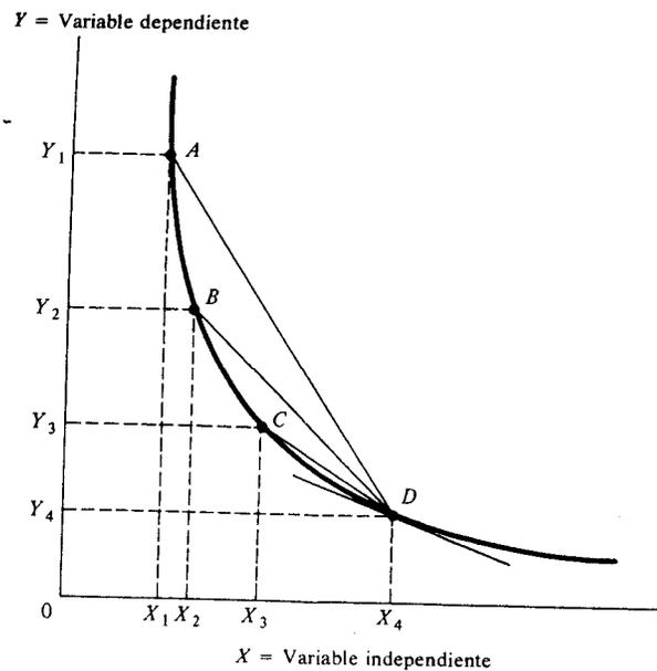
FIG. 2-6. Ilustración de una derivada como gradiente de una curva.
