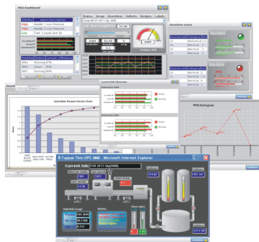
Figura 3.5: Tuppas Corp. SCADA
