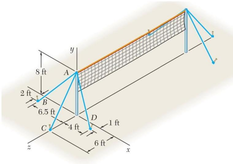
Determine el ángulo formado por los tirantes  $AB$  y  $AC$  de la red de voleibol que se muestra en la figura.
