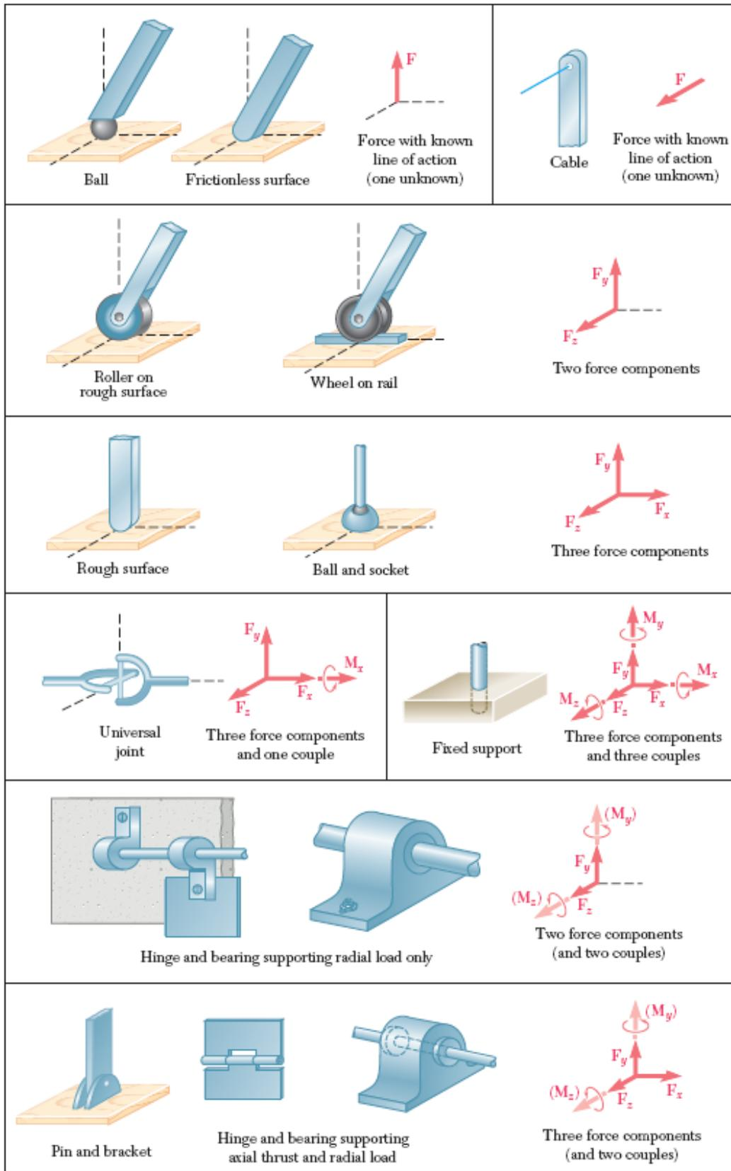
Figura 6.1 Reacciones en apoyos y conexiones
