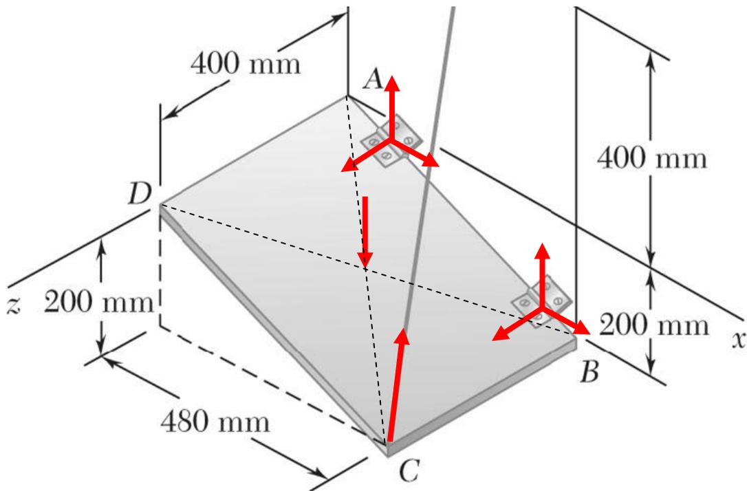
Como puede apreciarse en el diagrama de cuerpo libre podemos realizar una sumatoria de momentos con respecto al eje que pasa por el lado  $AB$  de la placa y así nos quedaría únicamente una ecuación con una incógnita; previamente definiremos al vector unitario en la dirección del eje  $AB$ , los radio vectores que van del punto  $A$  al punto de aplicación  $E$  del peso  $W$  de la placa y de la tensión  $T$  en  $C$  y, los vectores fuerza  $W$  y  $T$ .
