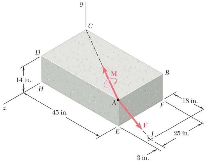
Una fuerza  $F$  de 46 lb y una par  $M$  de 2,120 lb·in, se aplican a la esquina  $A$  del bloque mostrado en la figura. Reemplace el sistema fuerza-par dado por un sistema equivalente fuerza-par en la esquina  $H$ .
