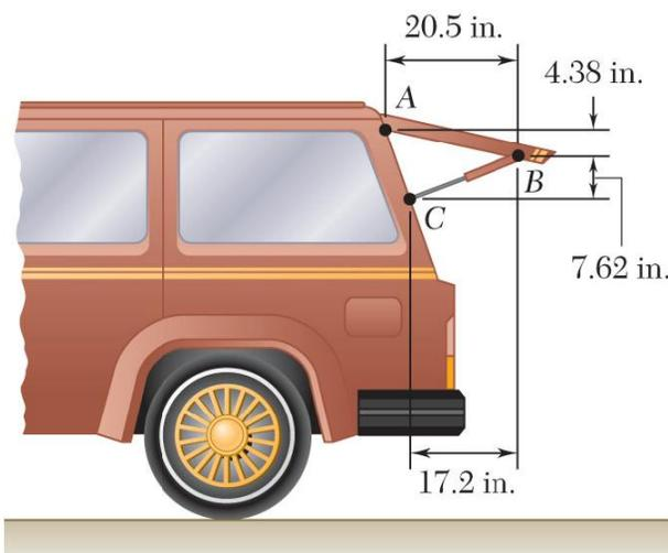
La ventanilla trasera de un automóvil se sostiene mediante el amortiguador  $BC$  que se muestra en la figura. Si para levantar la ventanilla se ejerce una fuerza de 125 lb cuya línea de acción pasa por el soporte de rótula en  $B$ , determine el momento de la fuerza alrededor de  $A$ .
