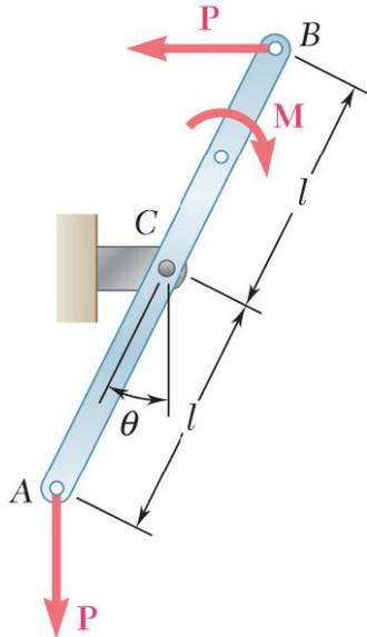
La barra  $AB$  se somete a la acción de un par  $M$  y a dos fuerzas, cada una de las cuales tiene una magnitud  $P$ . a) Obtenga una ecuación en función de  $\theta$ ,  $P$ ,  $M$  y  $l$  que se cumpla cuando la barra esté en equilibrio. b) Determine el valor de  $\theta$  correspondiente a la posición de equilibrio cuando  $M = 150 \text{ N}\cdot\text{m}$ ,  $P = 200 \text{ N}$  y  $l = 600 \text{ mm}$ .
