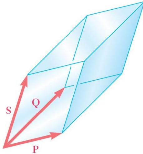
Figura 2.3 Paralelepípedo que tiene por lados los vectores  $S$ ,  $P$  y  $Q$ .
