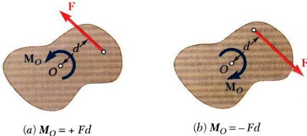
*Figura 1.4* Placa rígida sobre la que actúa una fuerza  $F$  (a)  $M_O$  en sentido antihorario, el vector momento apunta hacia afuera del plano de la figura. (b)  $M_O$  en sentido horario, el vector momento apunta hacia adentro del plano de la figura.
