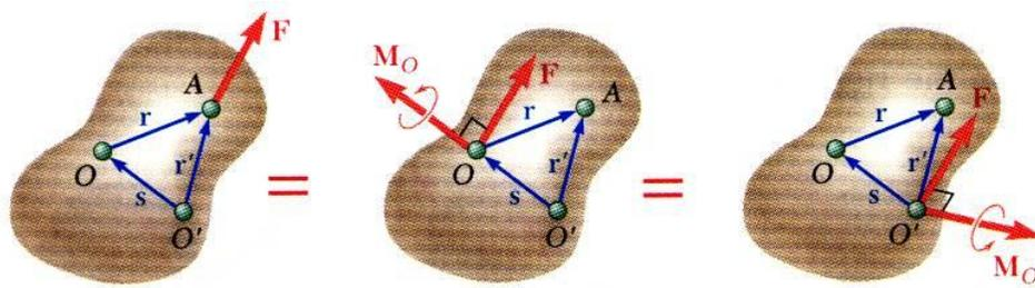
Figura 3.7 Sistema fuerza-par equivalente en  $O'$
