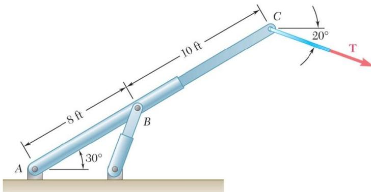
La tensión en el cable unido al extremo C de un aguilón ajustable ABC es de 560 lb. Reemplace la fuerza ejercida por el cable en C por un sistema equivalente fuerza-par en a) en A y b) en B.
