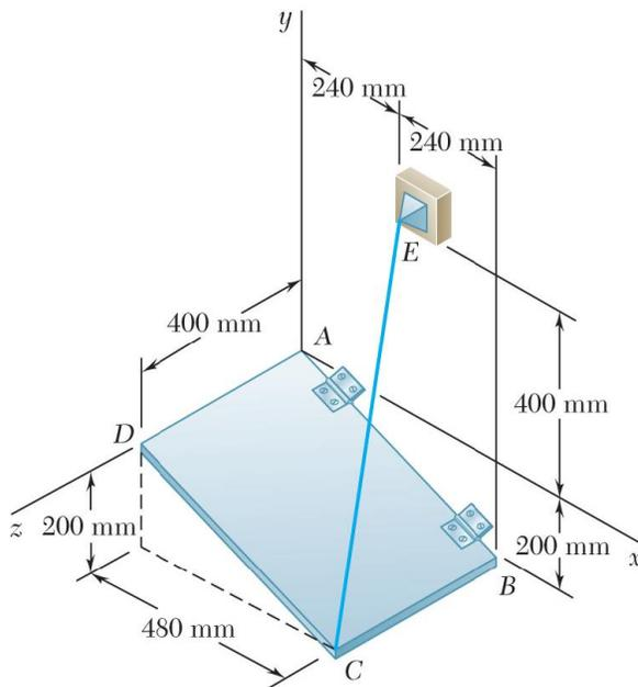
La placa  $ABCD$  de 50 kg se sostiene por medio de bisagras a lo largo del borde  $AB$  y mediante el alambre  $CE$ . Si se sabe que la placa es uniforme, determine la tensión en el alambre.
