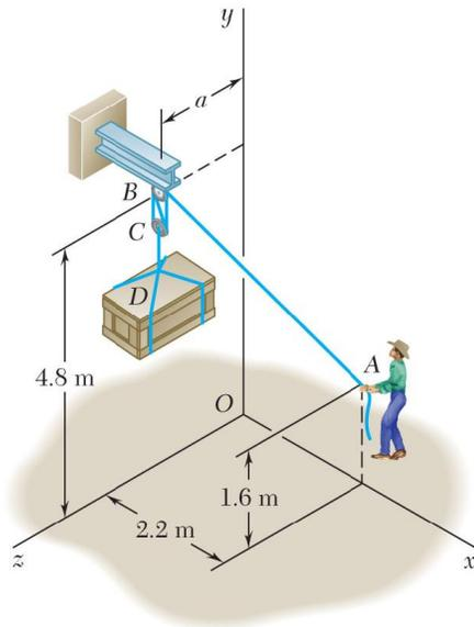
Para levantar una caja pesada, un hombre usa un bloque y un polipasto y los sujeta a la parte inferior de la viga I mediante el gancho B. Si se sabe que los momentos, de los ejes y y z, de la fuerza ejercida en B por el tramo AB de la cuerda son, respectivamente, de 120 N•m y -460 N•m, determine la distancia a.
