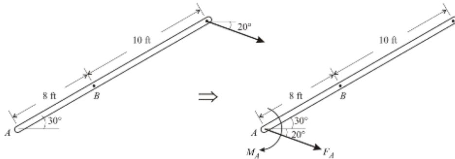
El momento  $M_A$  puede calcularse a partir de la suma del momento de las componentes con respecto al punto A; ambas componentes producen un par en sentido horario (CW):
