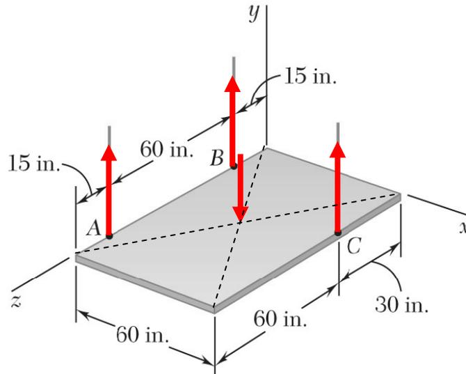
Sean  $T_A$ ,  $T_B$  y  $T_C$  las tensiones en cada uno de los alambres que sostienen la placa en los puntos  $A$ ,  $B$  y  $C$ , respectivamente. Aplicando la segunda condición de equilibrio en el punto  $B$ :
