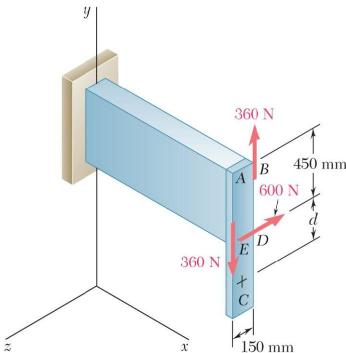
Una fuerza y un par se aplican al extremo de una viga en voladizo como se muestra en la figura. a) Reemplace este sistema por una sola fuerza  $F$  aplicada en el punto  $C$ , y determine la distancia  $d$  desde  $C$  hasta una línea que pasa por los puntos  $D$  y  $E$ . b) Resuelva el inciso a) suponiendo que se intercambian las direcciones de las dos fuerzas de 360 N.
