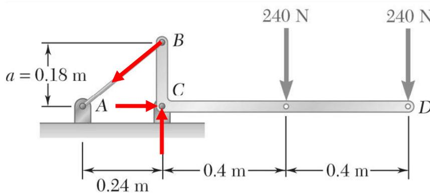
En el diagrama de cuerpo libre podemos identificar la fuerza de tensión  $T_{BA}$  actuando en  $B$  y las componentes de la reacción en  $C$ .
