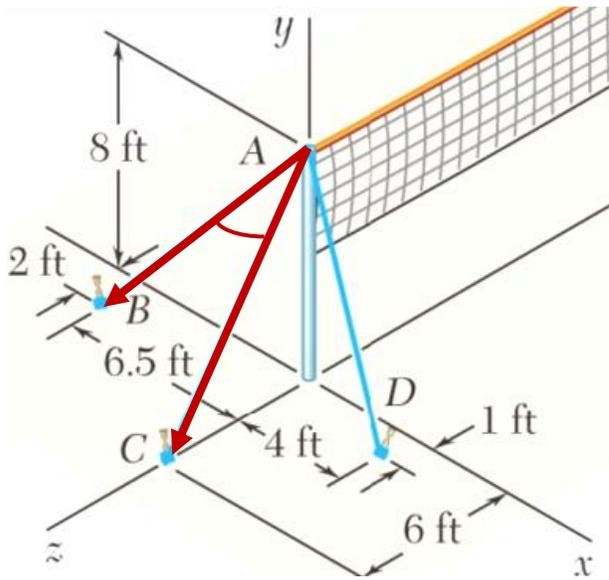
En la figura se indican los vectores  $\mathbf{AB}$  y  $\mathbf{AC}$ ; a partir de las coordenadas de los puntos  $A$ ,  $B$  y  $C$  podemos determinar sus componentes rectangulares y sus respectivas magnitudes:
