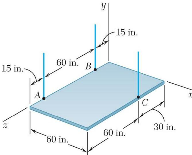
La placa rectangular que se muestra en la figura pesa 80 lb y se sostiene mediante tres alambres verticales. Determine la tensión en cada alambre.
