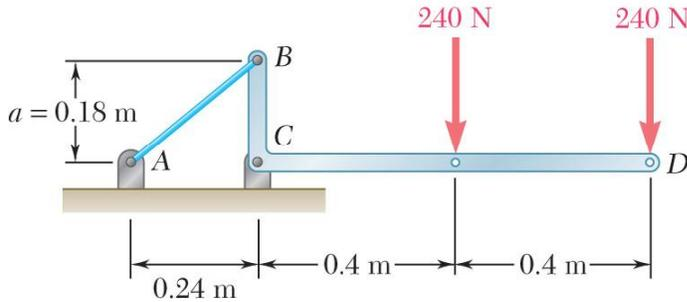
La ménsula  $BCD$  está articulada en  $C$  y se une a una barra de control en  $B$ . Para la carga mostrada, determine a) la tensión en el cable y b) la reacción en  $C$ .
