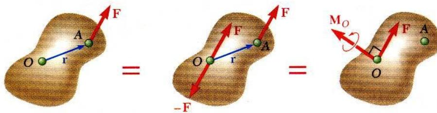
Figura 3.6 Sistema fuerza-par equivalente en  $O$
