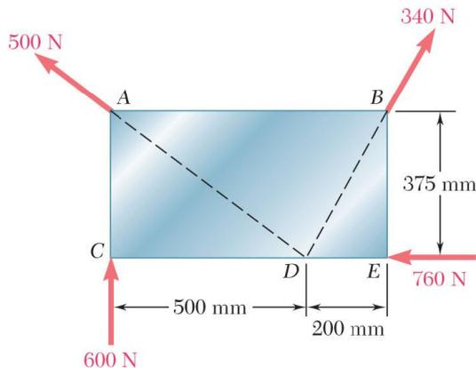
Cuatro fuerzas actúan sobre la placa de  $700 \times 375 \text{ mm}$  como se muestra en la figura. a) Encuentre la resultante de estas fuerzas. b) Localice los dos puntos en los que la línea de acción de la resultante interseca con el borde de la placa.
