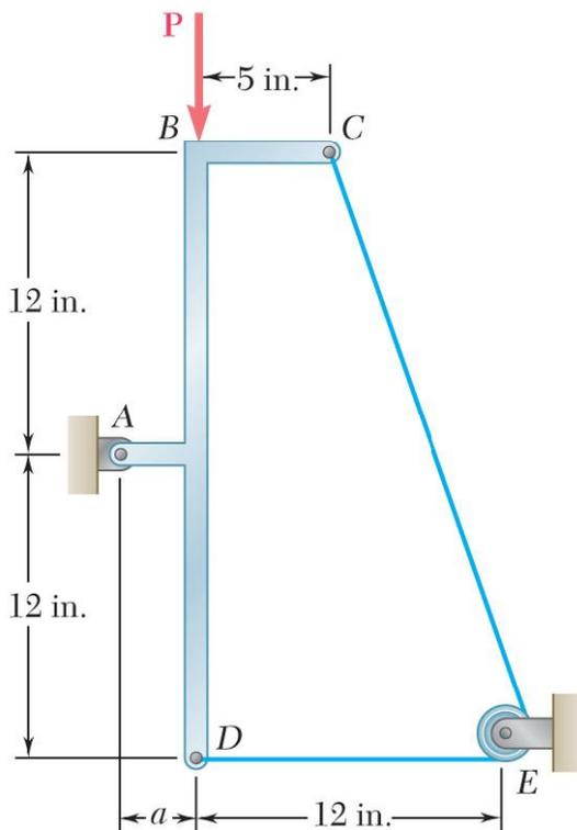
Se aplica una fuerza  $P$  con magnitud de 280 lb al elemento  $ABCD$ , el cual se sostiene mediante un pasador sin fricción en  $A$  y por medio del cable  $CED$ . Como el cable pasa sobre una pequeña polea  $E$ , se puede suponer que la tensión es la misma en los tramos  $CE$  y  $ED$  del cable. Para el caso en que  $a = 3$  in, determine a) la tensión en el cable, b) la reacción en  $A$ .
