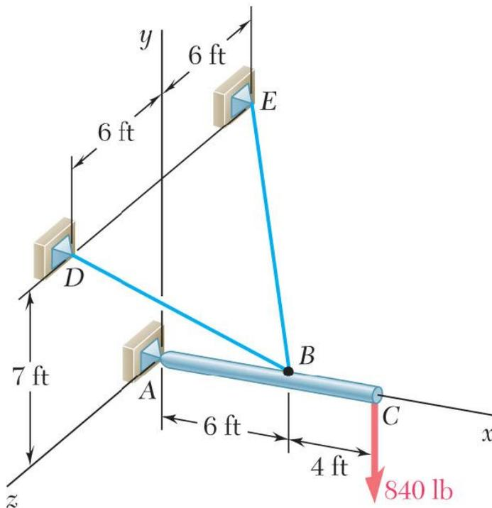
Un brazo de 10 ft está sometido a una fuerza de 840 lb como se muestra en la figura. Determine la tensión en cada cable y la reacción en el apoyo de rótula en A.
