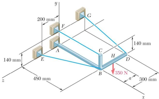
El bastidor  $ABCD$  se sostiene mediante tres cables y un apoyo de rótula en  $A$ . Para  $a = 150$  mm, determine la tensión en cada cable y la reacción en  $A$ .
