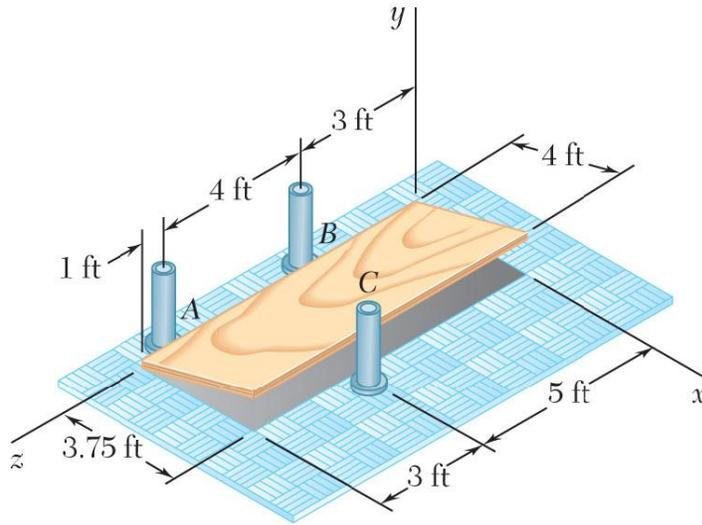
Una hoja de madera de 4 x 8 ft que tiene un peso de 34 lb ha sido colocada temporalmente en tres apoyos tubulares. El costado inferior de la hoja se apoya sobre pequeños collarines en A y B y el costado superior se apoya en el tubo C. Sin tomar en cuenta la fricción entre todas las superficies en contacto, determine las reacciones en A, B y C.
