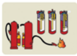
Extintores de Incendio con Presurización al momento de usarse
