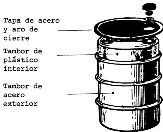
Figura B.37 a) - Receptáculo de plástico metido en un tambor de acero, tapa de acero y aro de cierre
