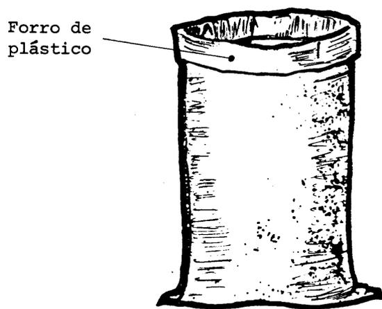
Figura B.39 b) - Saco textil con forro plástico (listo para ser cerrado)
