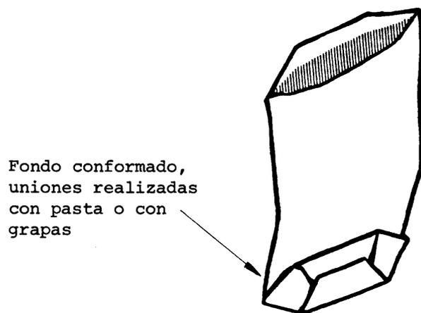
Figura B.41 c) - Saco con laterales plegados sin fuelle
