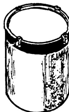
Figura B.62 b) - Tambor de plástico, tapa desmontable, cierre de palanca articulada
