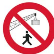
Prohibido dejar carga suspendida sin vigilancia
