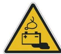
Ácido de baterías
