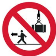
Prohibido el paso por debajo carga suspendida
