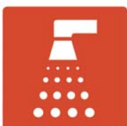
Zona protegida extinción automática
