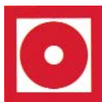
Pulsador de alarma
