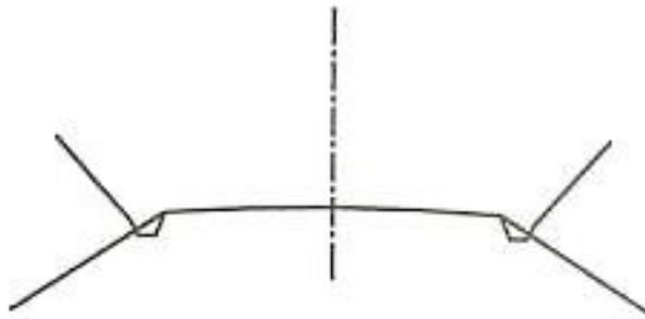
“Cajado” de un perfil es la operación consistente en dibujar sobre cada perfil transversal la sección tipo de la obra en ese punto. La intersección de ambos perfiles, el del terreno y el de la sección tipo, configura una superficie cerrada que se denomina, sección transversal.
