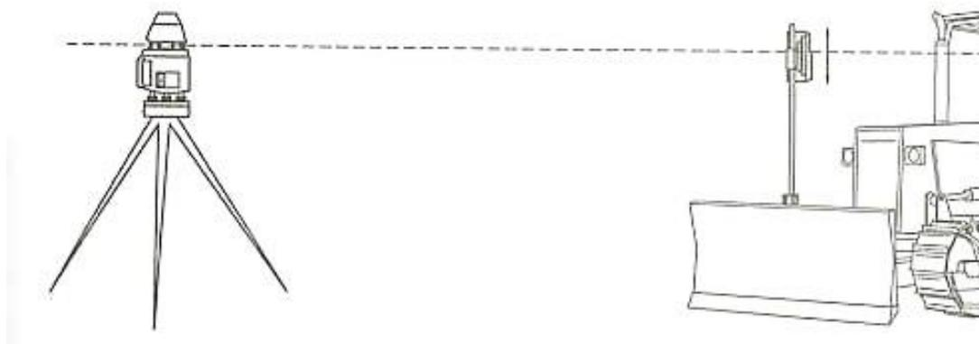
Las aplicaciones del emisor láser en el control de rasantes son múltiples. Situado el emisor de forma que el rayo emitido sea horizontal, al girar la cabeza rotatoria se engendra un plano horizontal, al girar la cabeza rotatoria se engendra un plano horizontal que se puede tomar como referencia para diversas operaciones: acotamiento de estacas, acondicionamiento de terrenos, nivelación de campos
