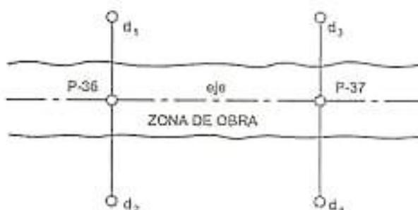
Para reponer el punto, bastará con materializar la alineación transversal, tendiendo una cuerda de albañil entre los dos puntos auxiliares, por ejemplo, y llevar sobre ella las longitudes correspondientes a las distancias de cada uno de ellos al punto del eje.
