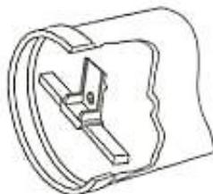
Mira para usar con el láser, en un tramo de tubo por instalarse.
