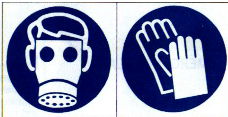
Figura 5. 11 : Ejemplos de símbolos de fácil entendimiento en señalización de lugares de almacenamiento y manejo de sustancias peligrosas.
