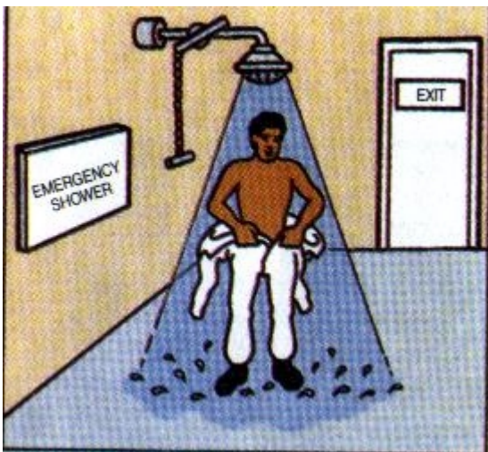
Figura 5.9 : Se deben diseñar duchas de emergencia en lugares adecuados , y se debe tener agua para lavado de ojos fácilmente accesible.
