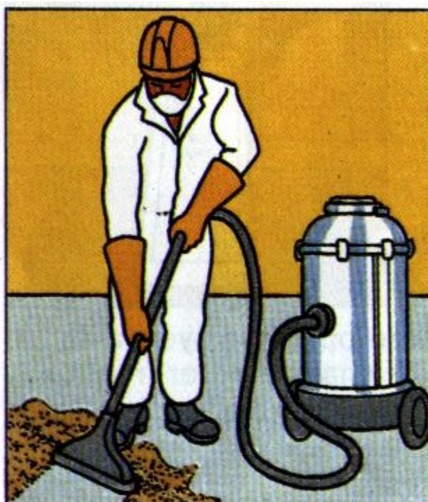
Figura 5. 8 : No se debe utilizar agua para lavar los derrames de líquidos. Se deben usar materiales absorbentes adecuados.
