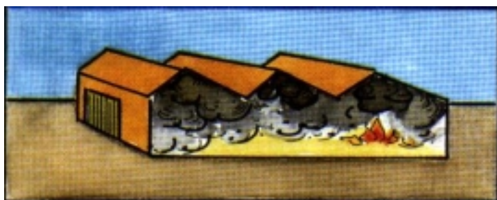
Bodega no ventilada – Fuego después de 3 minutos
