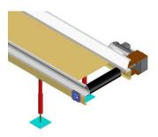
Este sistema de transporte consiste en una banda flexible sin fin, de caucho reforzado que se mueve sobre rodillos locos. Se usa preferentemente en transporte interior, por ejemplo: boca de mina a lugar de carga. Es un medio de transporte económico, aunque presenta el inconveniente de que la cinta puede recalentarse e incendiarse por el roce con los rodillos
