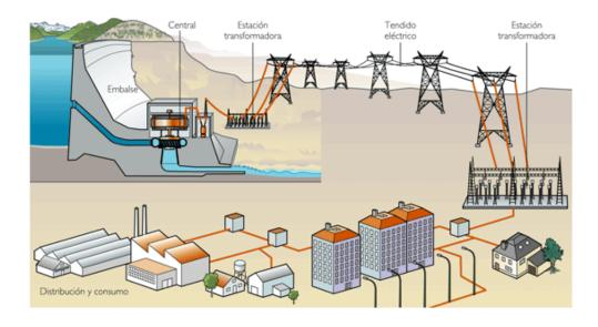
Este sistema consiste en transportar y distribuir la electricidad por líneas conductoras de alta tensión y centrales de transformación, aisladas, para modificar la tensión de corriente. Las obras de transformación son costosas. Los cables submarinos sólo permiten franquear los mares con su carga de energía
