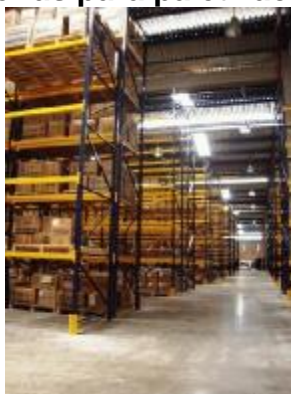
Figura 4. Estanterías para paletización convencional.
