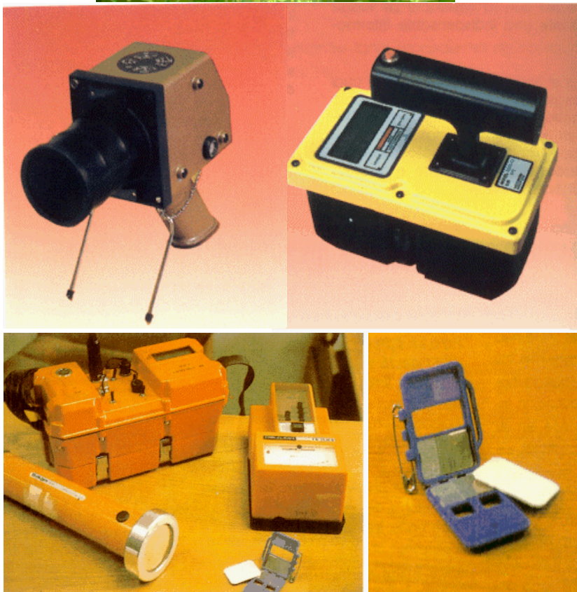
Figura 17.- a) Cámara de burbujas que permite visualizar las trayectorias de las partículas cargadas desviadas por un campo magnético, con una trayectoria dependiente de su carga, masa y velocidad. b) Otros sistemas de detección habituales para protección radiológica: Cámara de ionización. Detector Geiger. Monitor de contaminación, de centelleo. Dosímetro personal de película fotográfica.
