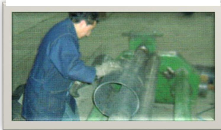
Fotografía 16: Rolado de planchas.
