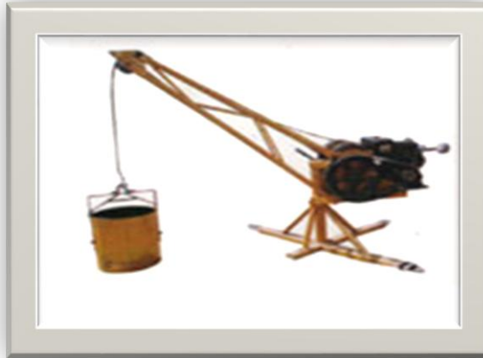
Fotografía 7: Elevador tipo pluma.
