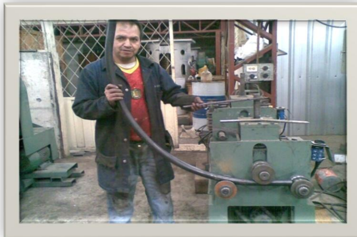
Fotografía 14: Rolado de tubos.
