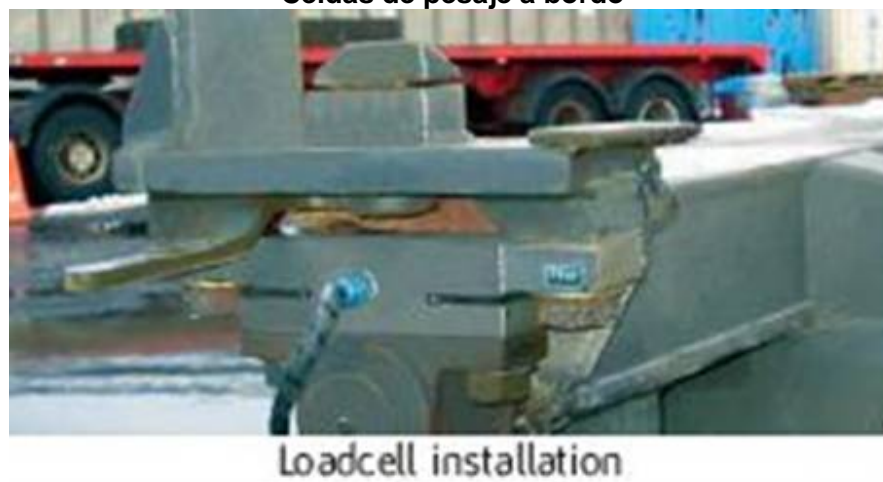
Figura N° 4-35 Celdas de pesaje a bordo
